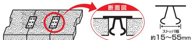
※各種隙間のサイズが異なるため、ストッパの幅を手で調節してください。
