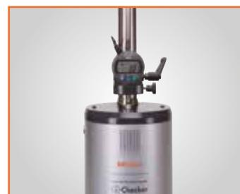
Calibrazione con comparatore di tipo digitale
