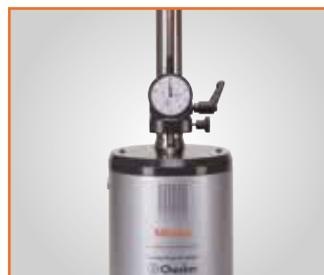
Calibrazione con comparatore di tipo analogico
