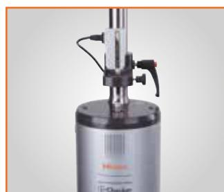
Ispesione utilizzando il trasduttore lineare
