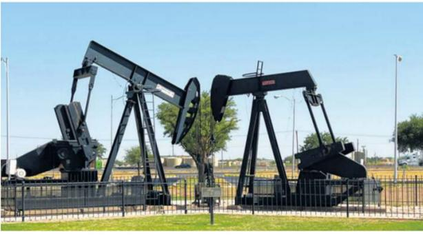
Mit diesen sogenannten Pferdekopfpumpen wird Öl gefördert.
